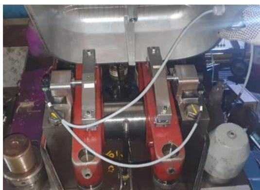
Encoder e sensor do balacin instalados em um dos geradores da UTE RAESA
