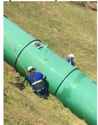
Sistema móvel, transdutor desenvolvido e montado na válvula de adaptação e utilização em campo
