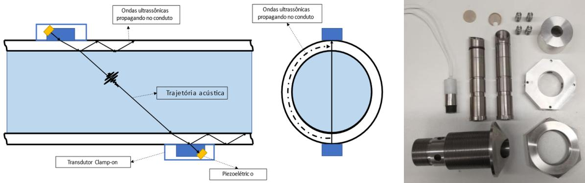
Esquema dos sensores e o sensor desenvolvido e instalado no laboratório
